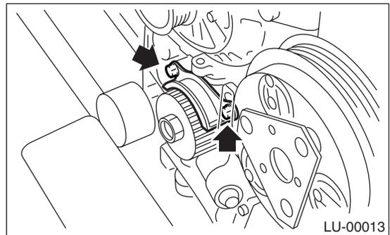
12) Remove the crank sprocket.
