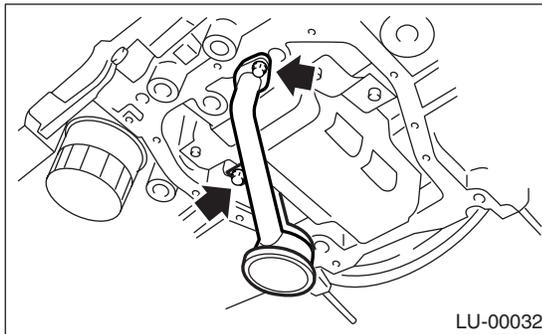
17) Remove the baffle plate.
