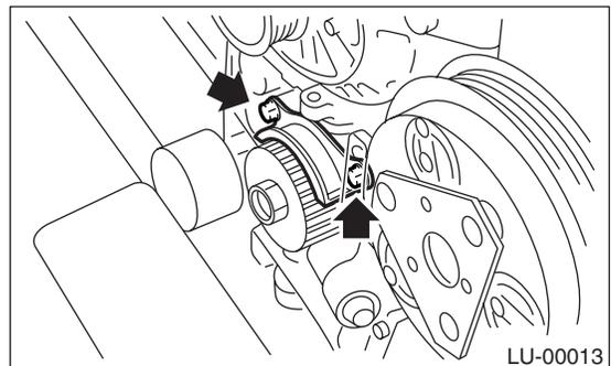
13) Remove the crank sprocket.
