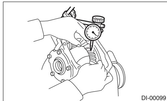
**3. HYPOID DRIVEN GEAR RUNOUT**
